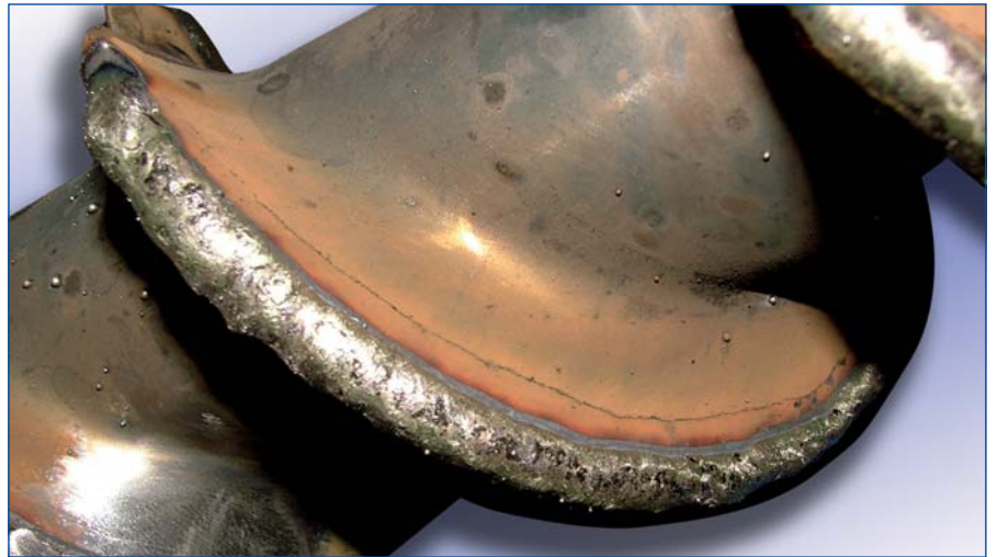
Gefügerisse durch fehlerhafte Wärmebehandlung
