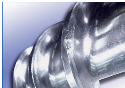
Schnecke mit Verschleißerscheinungen
