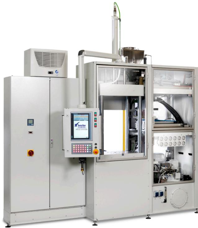
Vollautomatische Transferpress-Fertigungszelle DHT100 mit Werkzeugreinigung, Vorplastifiziergerät und Beschickungshandling
