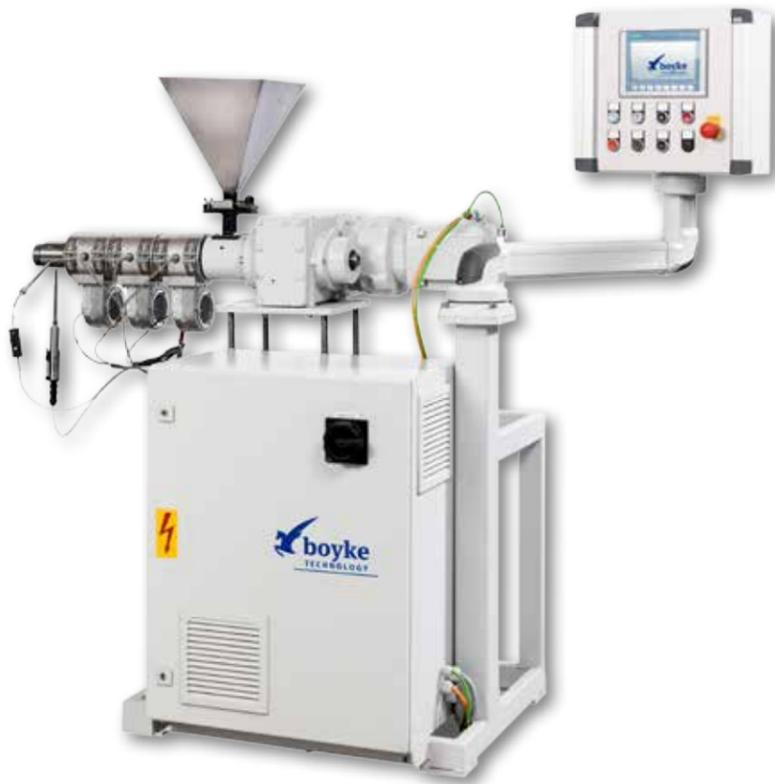
**Für den idealen Einsatz ist das Konzept bis ins kleinste Detail durchdacht.** Wechselbare Einzugsbuchsen mit unterschiedlichen Nutgeometrien, beheizbare Einzugszone für die Verarbeitung von Hochtemperaturwerkstoffen, austauschbare Plastifiziereinheiten für den Einsatz von Schnecken mit Größen 12 - 18 mm bei unterschiedlichen Längen-Durchmesser-Verhältnissen von 20 - 30, Hochleistungswerkstoff für alle Maschinenteile zur Vermeidung von Korrosion an Plastifiziereinheit, Flanschen und Werkzeugen.
