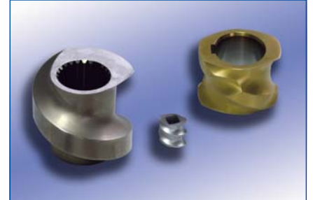
Schneckensegmente nach Oberflächenbeschichtung (links: TiB, mitte: CrN, rechts: TiN)
