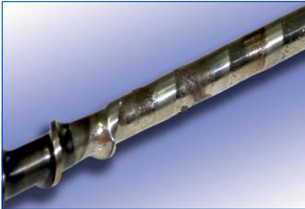
Schnecke mit starken Abrasionsschäden
