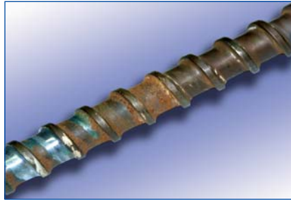
Korrodierte Schnecke mit Polymerablagerungen
